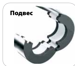
Комбинированное изделие из двух пенополиуретановых полуколец (к торцам приклеены полукольца из теплоизоляционного материала надлежащей марки, с наружным биндажом из ПВХ, имеющим самоклеящийся нахлест по продольному шву)
